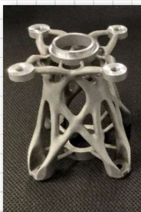
金属3Dプリンタ(アルミ材料)と DfAMを活用した 軽量化ロボットアーム
