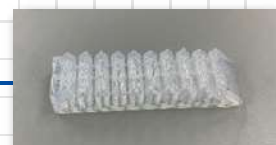
液体シリコン3Dプリンタを 活用したロボットハンド
