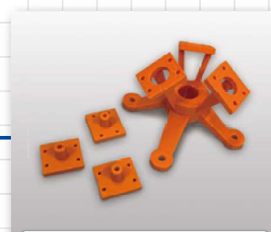
樹脂プリンタ(ABS)で 留め具部品を製造
